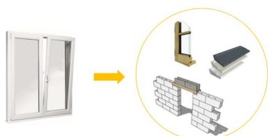
La simple prise en compte des dimensions et paramètres d'une fenêtre représentée sur la maquette 3D permet d'intégrer au chiffrage les **ouvrages associés**, mais non représentés graphiquement : le linteau, l'appui de fenêtre, l'ébrasement, etc.
