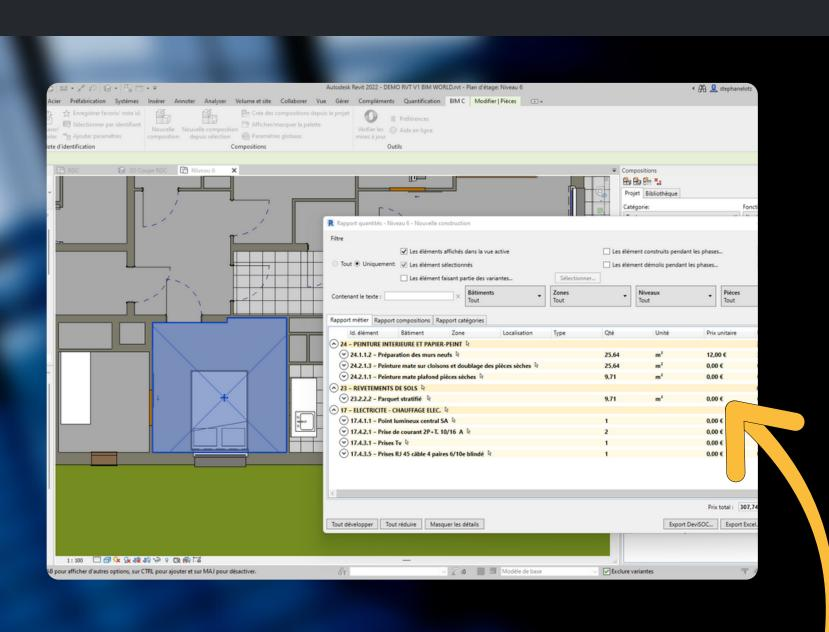
Grâce à BIM C, inutile de dessiner le projet dans son intégralité! Chaque objet produit de multiples ouvrages en fonction de formules de calcul personnalisables (compositions). BIM C affecte les ouvrages et quantités en tenant compte des paramètres des objets REVIT (épaisseur, largeur, matériaux, etc...). Ainsi, vous obtenez toutes les quantités par ouvrage sur REVIT.
